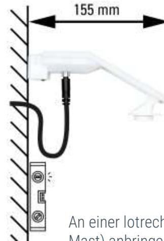
An einer lotrechten Wand (bzw. einem Mast) anbringen. Die Zuleitung zu einer Schlaufe legen, bevor sie in Wand oder Anschlussbox führt. In der Querrichtung horizontal (waagrecht) montieren.
