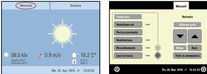
Questo menu permette la gestione degli azionamenti e dei dispositivi: Scegliere con i tasti con denominazione a sinistra l'azionamento o dispositivo che si vuole controllare. Dal menu **Sistema** è possibile modificare la sequenza delle voci nella lista.
