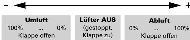
Jedes Mal, wenn der Zustand **AUS** erreicht wird, stoppt die Drehzahländerung automatisch, sodass kein direkter Wechsel zwischen Abluft- und Umluft-Modus möglich ist.
