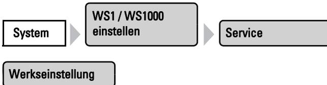
Wählen Sie **Werkseinstellung**. Geben Sie über das erscheinende Tastenfeld den Code „81“ ein und bestätigen Sie mit der Taste **OK**. Die Werkseinstellungen werden geladen und die Steuerung neu gestartet.
