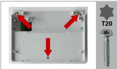
La partie inférieure du boîtier et la plaque de montage mural sont fixés au boîtier d'encastrement à l'aide de 3 vis : dévissez les vis et retirez la partie inférieure.
