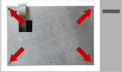
Tirez sur le câble de l'écran d'affichage à travers l'évidement de la plaque d'adaptateur et vissez ici la plaque sur le caisson encastré de l'ancienne commande. Utilisez les vis de l'ancien WS1000.
