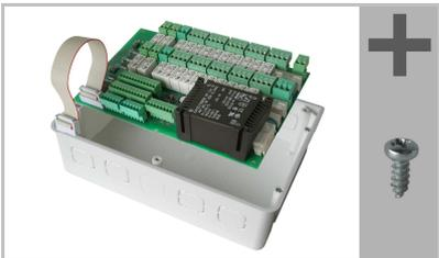
Retirez la platine du WS1000 Color. Insérez-la dans le boîtier encastré de l'ancien WS1000.
