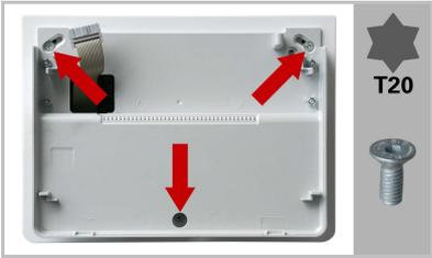
Saque el cable de la pantalla también por la hendidura de la placa de montaje en pared de WS100 Color y atornille la parte inferior en la placa adaptadora (se incluyen 3 unidades M4 de los tornillos de cabeza hueca de llave Allen con la placa adaptadora).
