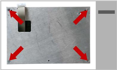
Separe el cable de la pantalla por la hendidura de la placa adaptadora y atornille la placa en la caja UP del control antiguo. Utilice los tornillos del antiguo WS1000.
