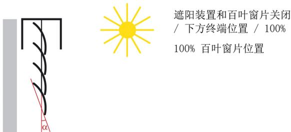
可将百叶窗片从其“垂直”位置（完全关闭，100%）调节至水平位置（完全打开， $\alpha = 90^\circ$ ）。所使用的百叶窗驱动装置在这时确定是否可以按多个小步幅进行该调节（例如对于 SMI 驱动装置），或者只能以少数几个大步幅进行（例如对于多数标准驱动装置）。
