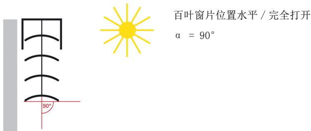
对于标准百叶窗，可超出其水平位置继续调节百叶窗片，直至百叶窗片调节结束，百叶窗开始向上移动。之后百叶窗片与垂直线形成  $90^\circ$  至  $180^\circ$  的角度。作为第二种方案，可以将该最大角度输入到参数“依据 0% 位置指令的百叶窗片角度，单位为 °”中。使用该设置可驶近约  $0^\circ$  至约  $180^\circ$  的所有角度。
