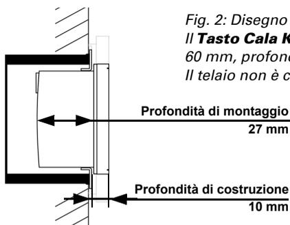
*Fig. 2: Disegno in sezione.*
