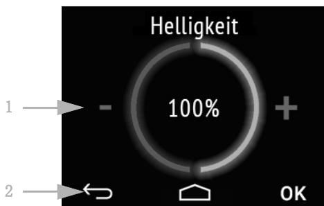
(1) 点击屏幕左半部分 (-)，以降低显示亮度。点击右半部 (+)，以提高亮度。设置范围为 1...100%。长时间触摸“-”或“+”，亮度会以 5% 的步幅变化。
