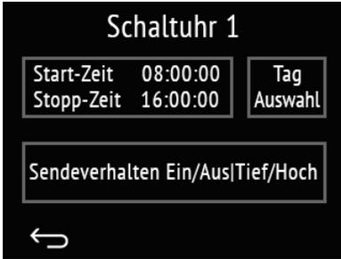
Abb. 28: Schaltuhr X Einstellung
