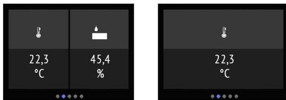
Auf der Display-Seite „Sensorik“ werden unter den (1) Symbolen für die Messgröße die (2) aktuellen Messwerte des Sensors dargestellt. Je nach Modell sind das Temperatur, Luftfeuchtigkeit und/oder Kohlendioxidgehalt der Luft.
