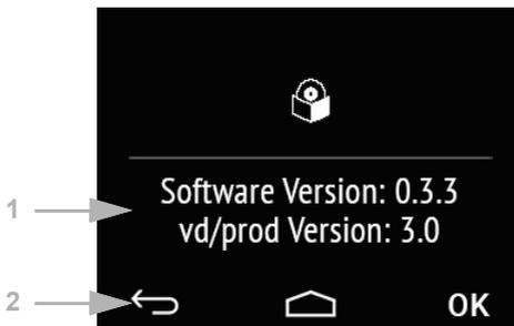
**(1)** Es wird die Software-Version angezeigt und die Version der Applikation (VD- oder KNXprod-Datei) die für das Gerät benötigt wird.
