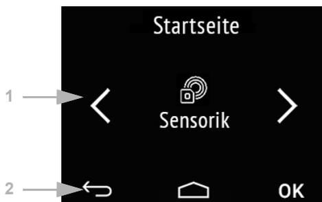
**(1)** Wechseln Sie mit den Pfeiltasten rechts/links zum gewünschten Menü für die Startseite. Angezeigt wird der Name des Menüs und gegebenenfalls ein Symbol.
