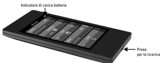
Caricare la batteria integrata del comando remoto con un comune caricatore USB (USB-2.0 microconnettore B). La ricarica annulla il blocco per il trasporto, attivo alla consegna del dispositivo. Il comando remoto può essere utilizzato solo dopo essere stato collegato alla rete elettrica per la ricarica.
