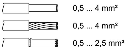
Figura 5: Secciones de cable conectables a borne
