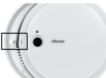
Abb. 8 Verschließen Sie das Gehäuse, indem Sie den Deckel aufsetzen und einrasten. Richten Sie dazu die Aussparung im Deckel an der Markierung im Sockel aus (der Präsenzsensoren muss durch die Öffnung im Deckel ragen).
