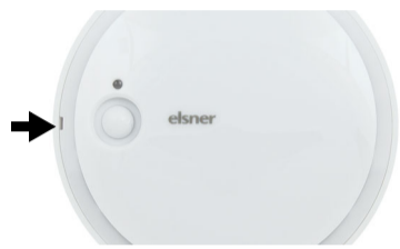
Fig. 3 Abra la carcasa. Levante cuidadosamente la cubierta de la base. Apalanque desde la hendidura, por ejemplo, un destornillador de cabeza ranurada.
