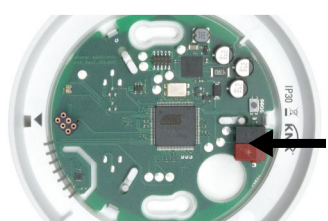
Fig. 6 Collegare il bus KNX al morsetto KNX.
