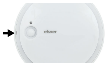
Fig. 3 Aprire l'alloggiamento. Sollevare con attenzione il coperchio dello zoccolo. Allineare all'incavo, per es. per con un cacciavite.
