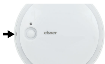
Fig. 3 Abra la carcasa. Levante cuidadosamente la cubierta de la base. Apalancque desde la hendidura, por ejemplo, un destornillador de cabeza ranurada.
