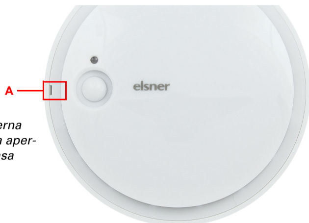
Fig. 3 Abra la carcasa. Levante cuidadosamente la cubierta de la base. Apalancque desde la hendidura, por ejemplo, un destornillador de cabeza ranurada.
