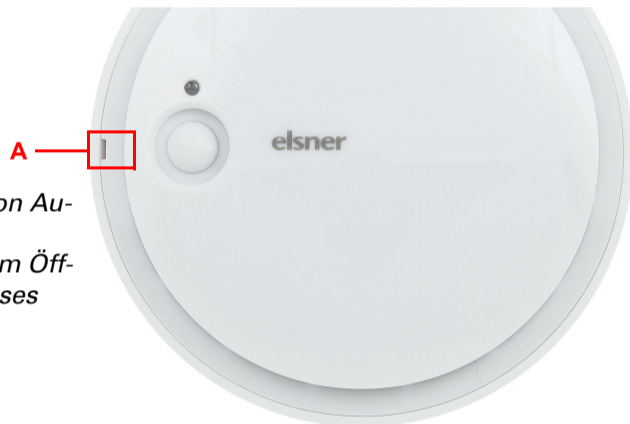
Abb. 3 Öffnen Sie das Gehäuse. Hebeln Sie dazu vorsichtig den Deckel vom Sockel. Setzen Sie an der Aussparung an, z. B. mit einem Schlitz-Schraubendreher.
