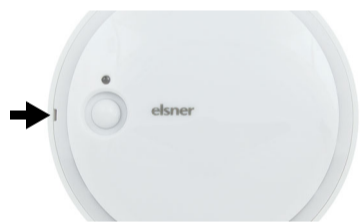
Abb. 3 Öffnen Sie das Gehäuse. Hebeln Sie dazu vorsichtig den Deckel vom Sockel. Setzen Sie an der Aussparung an, z. B. mit einem Schlitz-Schraubendreher.
