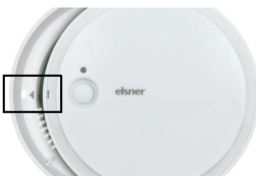
Abb. 7 Verschließen Sie das Gehäuse indem Sie den Deckel aufsetzen und einrasten. Richten Sie dazu die Aussparung im Deckel an der Markierung im Sockel aus (der Präsenzsensordurch die Öffnung im Deckel ragen).
