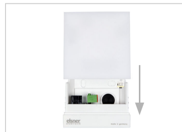
Fig. 12 Mettere il coperchio sul fondo. Si avrà l'inserimento della scheda del coperchio nel connettore femmina del fondo.
