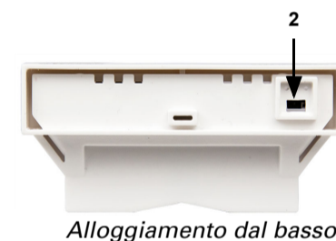
Fig. 13 a+b 1 LED di programmazione (sotto il coperchio semitrasparente) 2 Pulsante di programmazione per l'apprendimento dell'apparecchio
