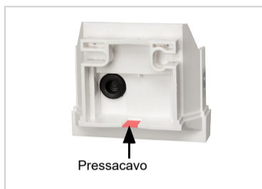
b) Se il cavo di allacciamento deve essere sistemato a parete, verrà liberato il pressacavo. Il cavo verrà poi introdotto nel dispositivo dal fondo della scatola.
