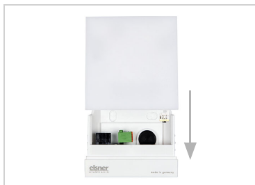
Abb. 12 Introduzca la cubierta sobre la parte inferior. De este modo se crea la unión enchufable entre la placa de circuitos en la cubierta y el zócalo de conexión en la parte inferior.
