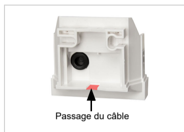
b) Si le câble de connexion doit être installé apparent, le passage du câble est brisé. Le câble est alors passé dans l'appareil via la partie inférieure du boîtier.
