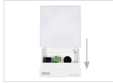
Fig. 12 Introduzca la cubierta sobre la parte inferior. De este modo se crea la unión enchufable entre la placa de circuitos en la cubierta y el zócalo de conexión en la parte inferior.
