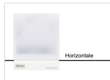
Abb. 2 Das Gerät muss in der Querrichtung horizontal (waagrecht) montiert sein.
