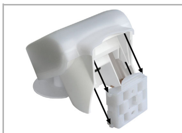
Fig. 15 Spostare la scatola dall'alto nel supporto montato. I denti di giunzione devono innestarsi nelle guide della scatola.
