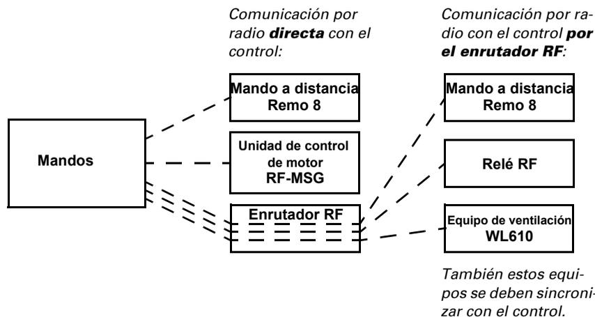
Los actuadores por radio (ventilador, relé, unidades de control de motor por radio...) solo se pueden utilizar *mediante el control* con el mando a distancia Remo 8. No se pueden encender *adicionalmente* con el mando a distancia directamente.
