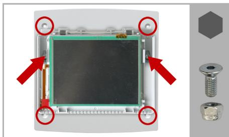
Avvitare l'unità display del WS1 Color con le viti fornite con la piastra adattatore. I dadi devono essere rivolti verso il basso.
