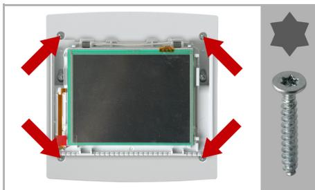
Avvitare la piastra adattatore con il WS1 Color sulle cassette incassate del WS20.
