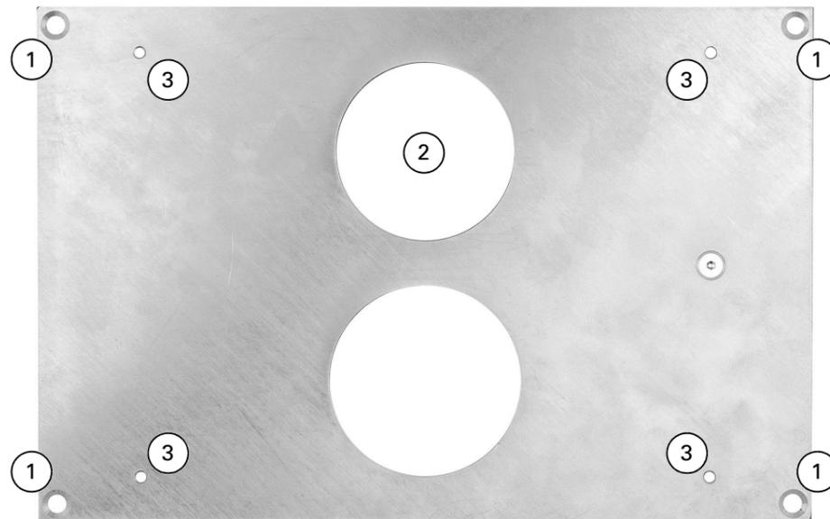
4. Vissez la **plaque d'adaptateur** sur le caisson encastré (fig. n° 1). Utilisez les 4 vis qui servaient à fixer l'ancienne commande sur le caisson encastré. Le câble de raccordement de l'écran doit être passé par l'ouverture ronde supérieure (fig. N° 2).
