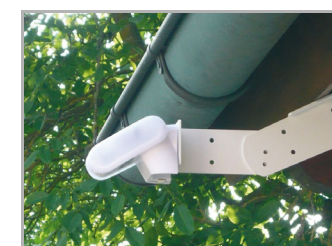
Fig. 8 Esempi di applicazione del braccio articolato: Per mezzo del braccio articolato, la stazione meteorologica sporge dalla copertura della cornice di gronda. Ciò permette l'azione non ostacolata del sole, vento e precipitazioni sui sensori.
