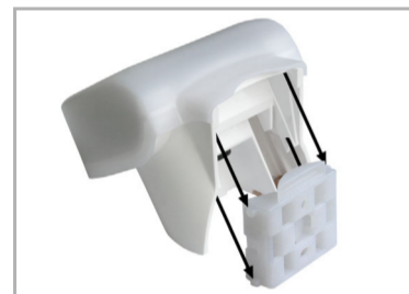
Fig. 14 Pousser le boîtier du haut dans le support monté. Les tenons du support doivent s'insérer dans les rails du boîtier.
