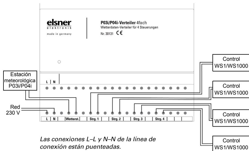
La conexión se realiza con un cable telefónico común resistente a los rayos UV (A-2Y(L)2Y 2x2x0,6 o A-2Y(L)2Y 2x2x0,8). La estación meteorológica y el control (u otros distribuidores P03i) se pueden conectar independientemente de la polaridad.
