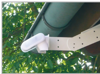
Fig. 1 la station météorologique s'oriente par le bras articulé sous le larmier. Le soleil, le vent et les précipitations peuvent agir sans obstacle sur les capteurs.
