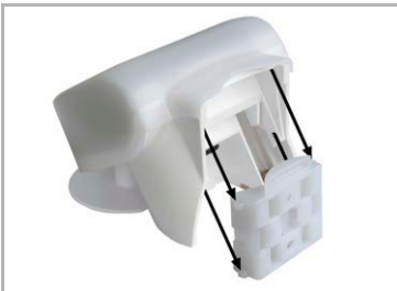
Abb. 21 Placez le boîtier par le haut dans le support monté. Les tenons du support doivent s'enclencher dans les rails du boîtier.
