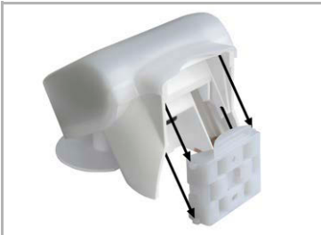
Abb. 21 Schieben Sie das Gehäuse von oben in den montierten Halter. Die Zapfen des Halters müssen dabei in den Schienen des Gehäuses einrasten.
