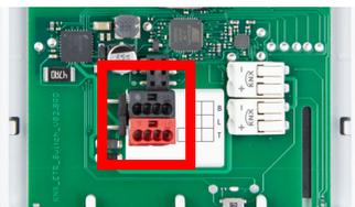
Wenn sich hinter dem Gerät ein Hohlraum befindet, z. B. bei Verwendung einer Dose, dann können Sie die rot-schwarze KNX-Busklemme zum Anschluss verwenden.
