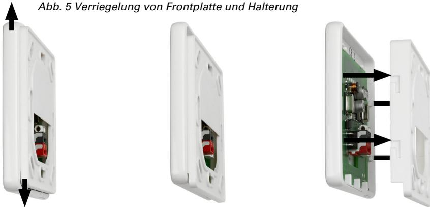
Schrauben Sie die Halterung auf Wand oder Dose. Die Anschlussdrähte (Busleitung +/ -) werden durch die Öffnung in der Halterung geführt.
