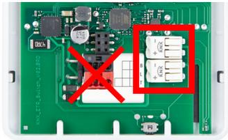
Entfernen Sie die rot-schwarze KNX-Busklemme, sie wird nicht benötigt.
