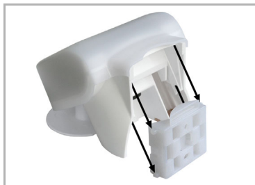
Fig. 13 Spostare la scatola dall'alto nel supporto montato. I denti di giunzione devono innestarsi nelle guide della scatola.
